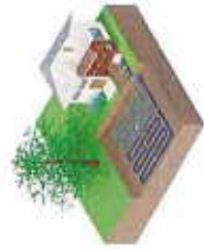
Pompe à chaleur sur capteurs enterrés horizontaux
