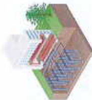
Pompe à chaleur sur sondes géothermiques
