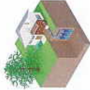
Pompe à chaleur sur corbeilles géothermiques
