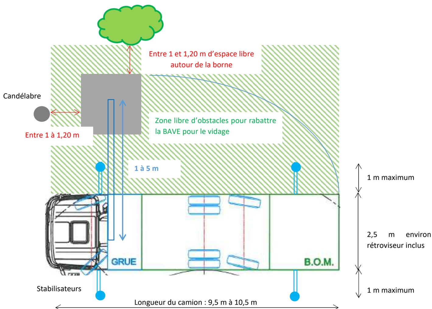
Le camion grue pourra être amené à sortir ses stabilisateurs pour le vidage. Ces derniers peuvent être déployés à une distance maximale de 1m.
