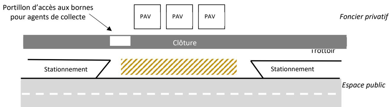
Attention, pour les dispositifs restreignant l'accès au véhicule seulement, le garde-au-sol du véhicule de collecte est de 22 cm. En cas d'utilisation de sphères demi-lunes ou bordures, la benne peut rouler par-dessus lors des manœuvres, il faut donc veiller à un ancrage solide et que la **hauteur maximale ne dépasse pas 19cm**.
